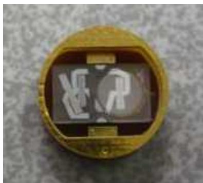
La technologie, que SCHRADER a développée avec l'Institut FEMTO-ST et l'entreprise SENSOR, associe les fonctions de capteur de pression/température à celle d'une valve traditionnelle.
