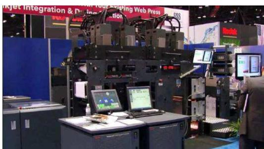
L'innovation de la société **AXODE** est exploitée dans le domaine de l'impression numérique et de l'impression offset de documents. La solution embarquée d'imagerie couleur capture l'image entière des pages en couleur, effectue un contrôle qualité d'impression et un contrôle d'alignement des couleurs primaires de l'impression variable (Noir, Cyan, Magenta, Jaune) avec une précision de 30 µm, et cela à la vitesse de l'impression de l'offset à 10 mètres/seconde.
