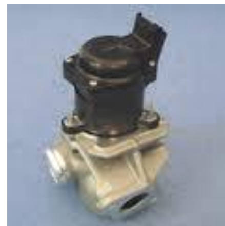
Vanne EGR à commande électrique
