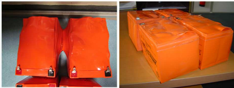
Etat de batteries Plomb Acide après emballage thermique
