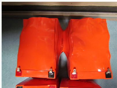
Etat de batteries Plomb Acide après emballage thermique
