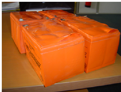
Etat de batteries Plomb Acide après emballage thermique
