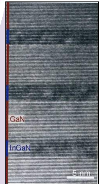
Image TEM des couches constituant les puits quantiques
