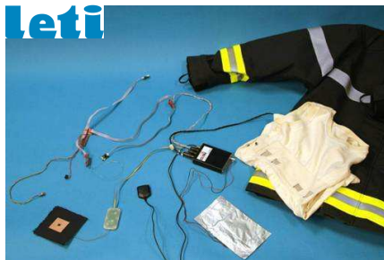
Capteurs intégrés dans le textile pour le monitoring physiologique
